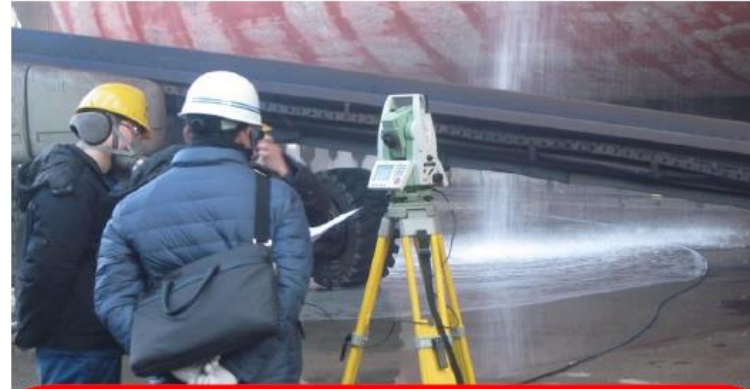
좌표값 확인 및 선체 외판 마킹작업
